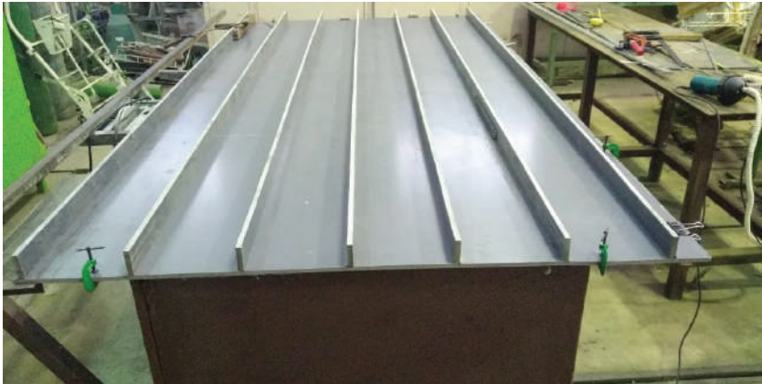
Konstruksi long bed alat tanam padi model jajar legowo
