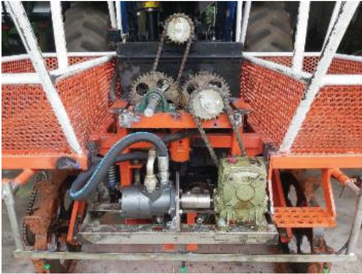
Komponen pisau pemotong setelah modifikasi penggerak alat-mesin tanam ubi kayu
