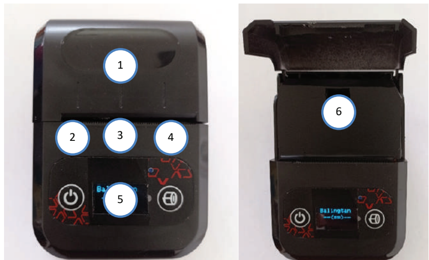
Tampilan prototipe deteksi cepat logam berat (1. Tempat sampel (kuvet), 2. Tombol power/stop, 3. Display, 4. Tombol start, 5. Konektor pengisian battery, 6. Lubang tempat kuvet pengukuran)
